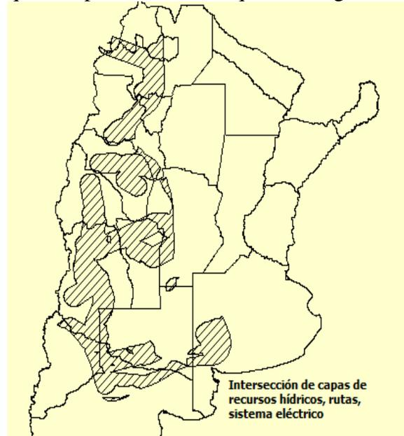
Intersección de capas de rutas, líneas eléctricas, ríos, en un contorno de 50km en la zona de radiación superior a 4,75 kWh/m<sup>2</sup>. Figura 8
